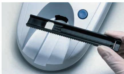
Teststreifenschlitten nach jedem Arbeitstag mit Wasser bzw. Reinigungs- und Desinfektionsmitteln reinigen.
