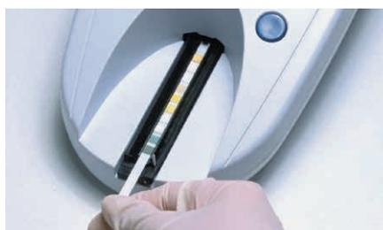
**2** Teststreifen mit den Testfeldern nach oben bis zum Anschlag in die Halterung des Teststreifenschlittens einlegen. Das Teststreifenende muss ca. 2 mm unter die Klemme eingeschoben werden.
