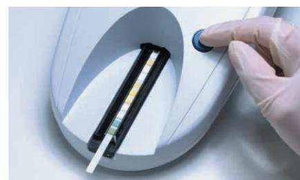
**3** START-Taste drücken\*. Nach dem Beep-Ton schliesst sich der Niederhaltebügel. Achten Sie darauf, dass der Teststreifen exakt mittig in der Vertiefung des Teststreifenschlittens liegt.
