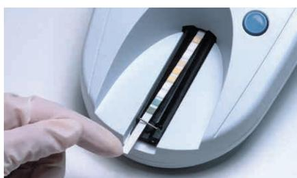
**4** Falls nötig, Teststreifen mit der Hand in die richtige Position rücken.
