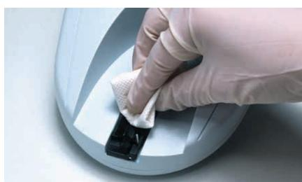
**5** Nach der Messung Teststreifen entnehmen und wegwerfen. Urinreste mit einem fusselfreien Tuch abwischen.
