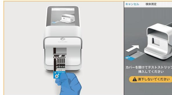
3. 画面の指示に従い、機器のカバーを開き、テストストリップを優しく挿入します。その際にストリップの左側にある黒いアライメント・リップを機器の黒線とぴったり合わせます。画面に指示が出るまで検体は滴下しないでください。新しいロットのテストストリップを初めて使用する場合は、ロット校正ファイルをインストールしてください。詳細については、ルミラ・プラットフォームユーザーマニュアルを参照してください。
