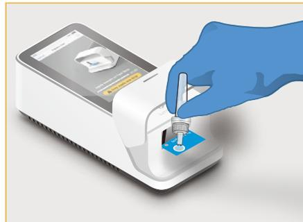
6. 機器の画面の指示に従い、テストストリップの検体滴下エリアに検体を1滴(20~36µL)滴下します。
