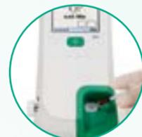
2. Depositare 150 µl di campione di sangue intero eparinizzato utilizzando la pipetta Roche cardiac
