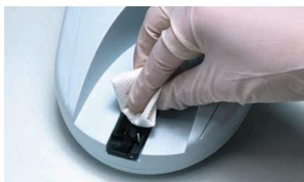
**5** Une fois la mesure terminée, retirer la bandelette et la jeter. Essuyer tout reste d'urine à l'aide d'un tissu non pelucheux.
