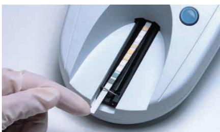
**4** Si nécessaire, mettre la bandelette dans la bonne position d'un mouvement de la main.
