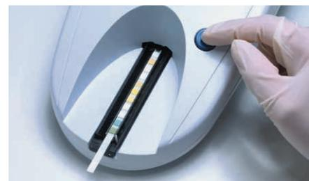
**3** Appuyer sur la touche START\*. L'appareil émet un signal sonore, et la barrette de maintien s'abaisse. Veiller à ce que la bandelette soit positionnée exactement au milieu de la glissière.
