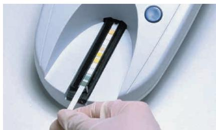
**2** Introduire la bandelette dans la glissière, zones réactives tournées vers le haut, jusqu'au déclic. L'extrémité de la bandelette doit dépasser de 2 mm env. de la barrette de maintien.
