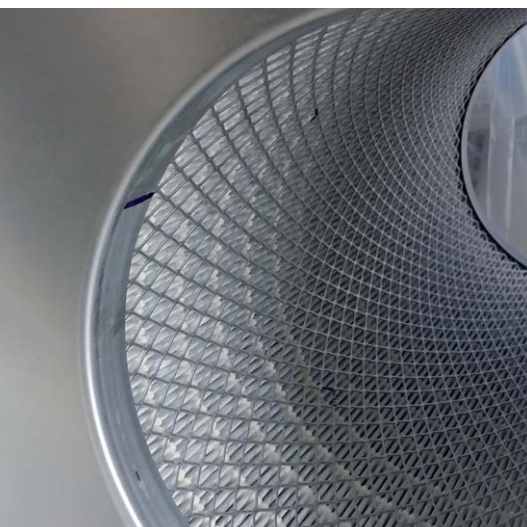
▲ Obr. č. 3: HEPA filtr kabinové vzduchotechniky letounu Airbus A 319/320/321
