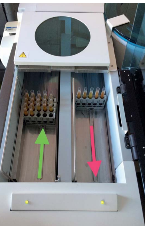
▲ Obr. č. 2: Vstup vzorků do analyzátoru (zelená šipka) a výstup (červená) přehledně z jednoho obslužného bodu. Kontinuální vkládání výrazně zrychluje vyšetření
