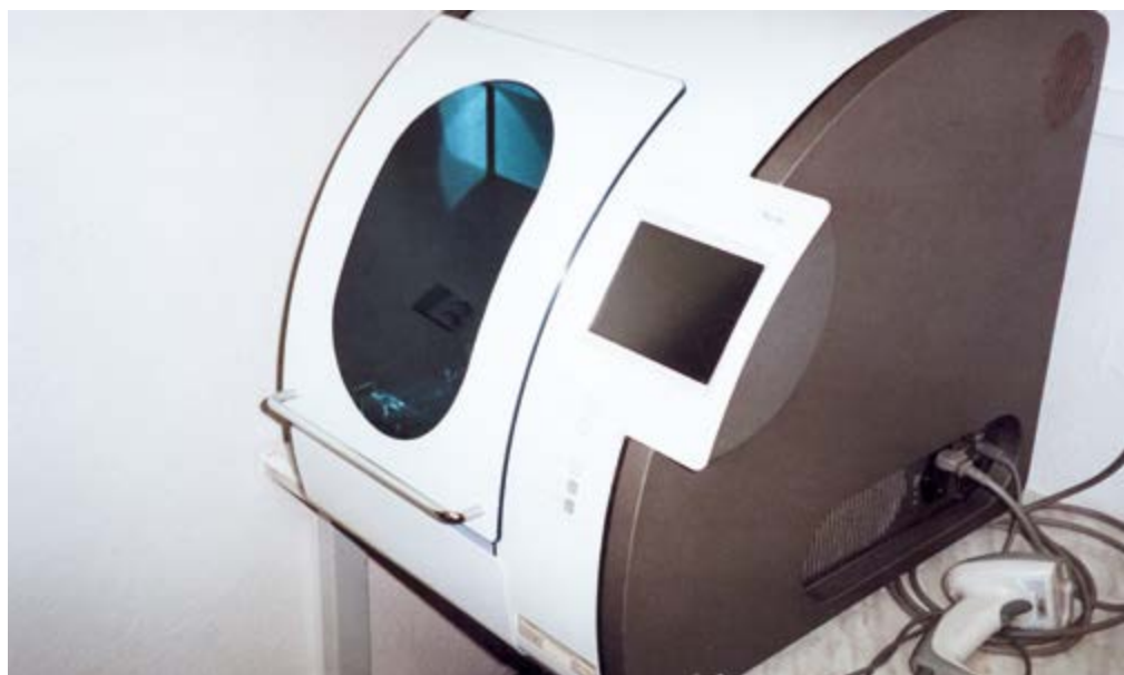
▲ Obr. č. 6: Automat pro izolaci nukleových kyselin z biologických vzorků pracující s uzavřeným kazetovým systémem MagNA Pure Compact
