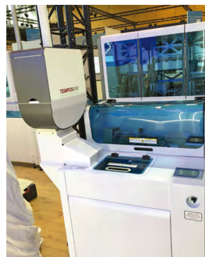
▲ Obr. č. 2: Bulk loader CCM napojený na potrubní poštu
