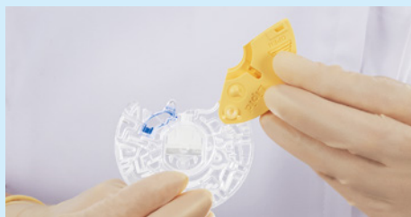
⑤脂質測定試薬ディスクを袋から取り出した後、ヒンジカバーを完全に開けます。
