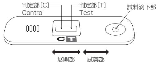
テストプレートの試料滴下部に試料を滴下すると白金 - 金コロイド標識抗SARS-CoV-2抗体が溶解し、試料中のSARS-CoV-2抗原と免疫複合体を形成します。この免疫複合体は展開部を毛細管現象により移動し、展開部に固定化された抗SARS-CoV-2抗体に捕捉され、判定部[T]に白金 - 金コロイドによる黒色のラインを形成します。本品はこの黒色のラインを目視で確認し、試料中のSARS-CoV-2抗原の存在の有無を判定します。
