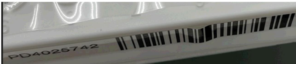
Изображение 1: Дефект — фотография из рекламации CN-1021961. Можно заметить слегка изогнутую этикетку со штрихкодом.
