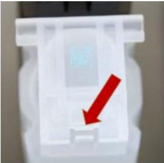
Кромка крышки со сломанным креплением
