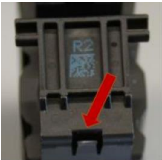
Крышка реагента со сломанным креплением
