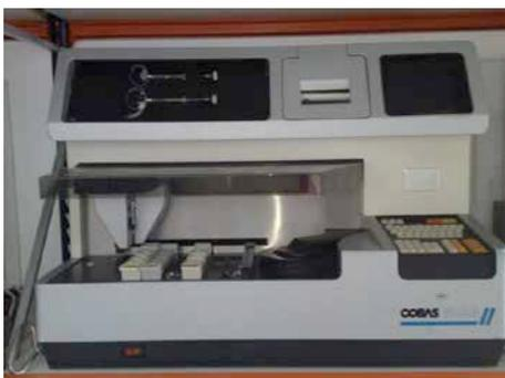
Новым этапом в производстве анализаторов стала разработка технологии электрохемилюминесценции. Это позволило максимально автоматизировать процесс иммуноанализа и, как следствие, увеличить аналитическую воспроизводимость (прецизионность).
