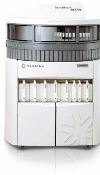
**Иммуногистостейнер BenchMark® ULTRA** — это полностью автоматизированная система для проведения иммуногистохимических реакций и *in situ*-гибридизации. Аппарат автоматически выполняет все этапы приготовления препаратов, включая депарафинизацию, раскрытие антигена и подкраску в одной системе.
