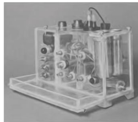
Рисунок 1. Первая система для анализа газового состава крови, содержащая три основных электрода: \text{pH} , \text{pO}_2 , \text{pCO}_2 2
